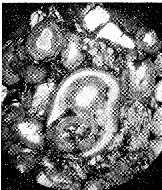
FIG. 1. — Oolites de l'étang de La Palme (Aude) : Lumière polarisée, grandissement 50. Structure concentrique, liée à la présence de couches d'aragonite d'épaisseur et de pureté variables, nettement visible. Noter une oolite de grande dimension constituée autour d'un noyau formé de deux oolites soudées entre elles. Le noyau de l'une est formé de quartz, celui de l'autre est une sorte de microgalet d'une roche microquartzéuse de couleur foncée probablement métamorphique ou éruptive (1).
