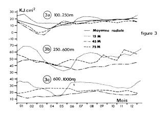
Sur la figure 3a, relative à la couche 100-250 m, la courbe en trait plein représente la moyenne de W de toutes les stations de la radiale. Le même cycle se retrouve sensiblement à chaque station et le minimum constaté ne peut être qu'une advection verticale (se produisant au même temps que le refroidissement hivernal superficiel).
