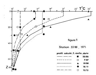
Cette station est située à 55 milles de Nice (35 milles de Calvi). Les profils sont calculés à partir de l'apport solaire d'un profil d'extinction\* et de la température de surface moyenne de la radiale.
