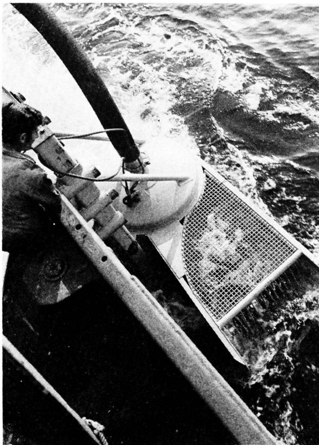
Des échantillons, prélevés en cours de ramassage, ont montré que le produit collecté contenait 80 % d'hydrocarbures. Le bateau dépollueur a aisément poursuivi la nappe, sa mobilité lui permettant de pourchasser le liquide polluant poussé par le vent.
